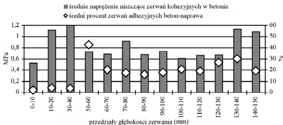
Rys. 2. Naprężenie niszczące pull-off zerwań kohezyjnych w betonie i udział procentowy zerwań adhezyjnych beton-naprawa w funkcji głębokości następowania zerwań
