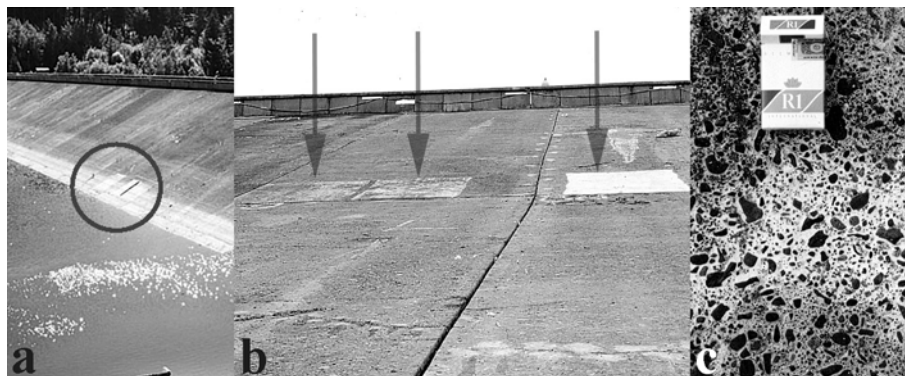
Rys. 6. Badania terenowe trwałości zapraw naprawczych wyeksponowanych w strefie falowania (OLSZAMOWSKI i TEŻYCKI 2004)
